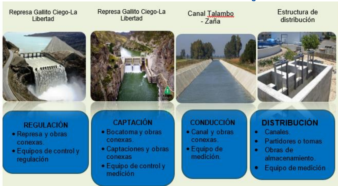
Gráfico 10. Sistema de Infraestructura de Riego
